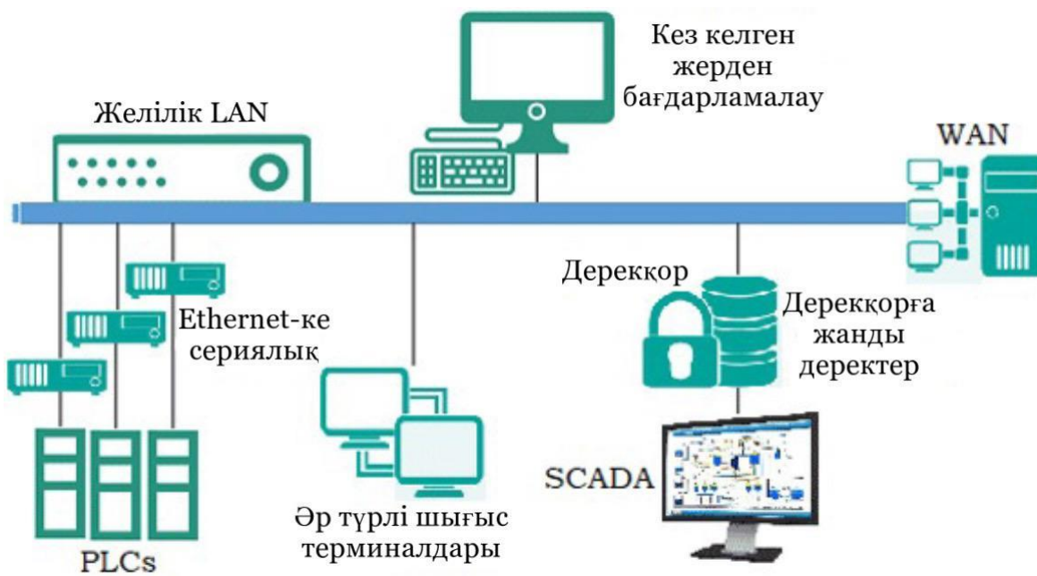
2.2 Сурет - SCADA аппараттық архитектурасы
